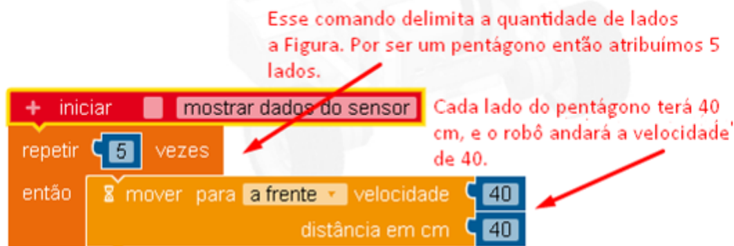
Figura 8 - Programação da construção do pentágono realizada pela Katherine.
