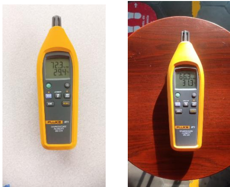
Figura 9. Mediciones T y RH en punto 1 4:30pm (120523). Laboratorio de Instalaciones Eléctricas y Laboratorio de Construcciones Electromecánicas, respectivamente.
