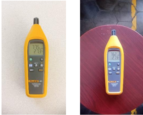
Figura 8. Mediciones T y RH en punto 1 9:30am (120523). Laboratorio de Instalaciones Eléctricas y Laboratorio de Construcciones Electromecánicas, respectivamente.
