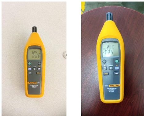
Figura 10. Mediciones T y RH en punto 1 9:30am (260623). Laboratorio de Instalaciones Eléctricas y Laboratorio de Construcciones Electromecánicas, respectivamente.
