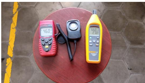
Figura 6. Mediciones T y RH en punto 1 9:30am (230523). Laboratorio de Construcciones Electromecánicas.
