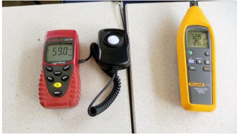
Figura 4. Mediciones T y RH en punto 1 9:30am (190423). Laboratorio de Instalaciones Eléctricas.
