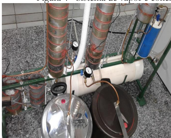
Figura 4 - Sistema de vapor e conexões (a) e panelas de pressão e fogareiro a gás (b).
