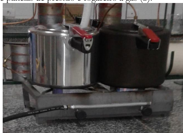
Figura 4 - Sistema de vapor e conexões (a) e panelas de pressão e fogareiro a gás (b).
