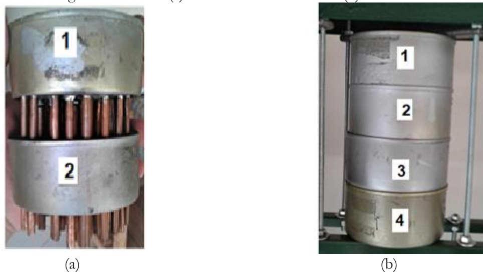
Figura 7 - Imagem do interior (a) e estrutura física externa (b) dos trocadores de calor
