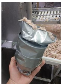
Figura 5. Lata deteriorada por atasco en la máquina selladora al vacío.
