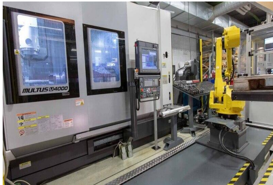
Figura 2: Célula de Usinagem Automatizada com Máquina CNC e Robô Industrial
