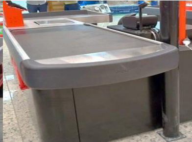
Figura 4 - Esteira interligada ao balcão de caixa por onde os produtos são dispostos pelos clientes para serem registrados.
