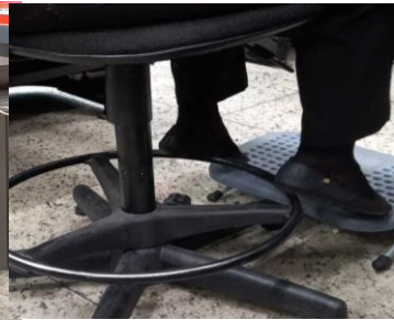
Figura 5 - Descanso para pés, com regulação de altura e inclinação.
