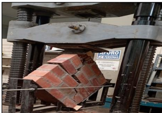
Fig. 9. M-1 obtuvo una carga máxima (kg) 4900
