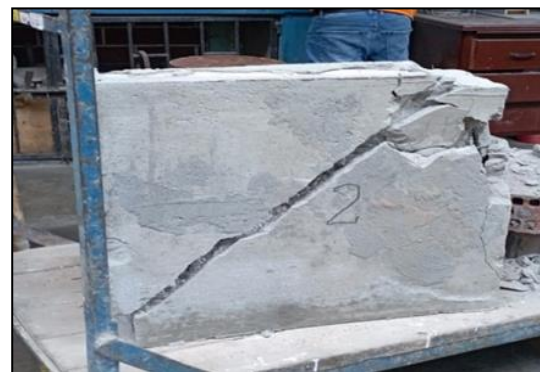
Fig. 10. M-2 obtuvo una carga máxima (kg) 3500
