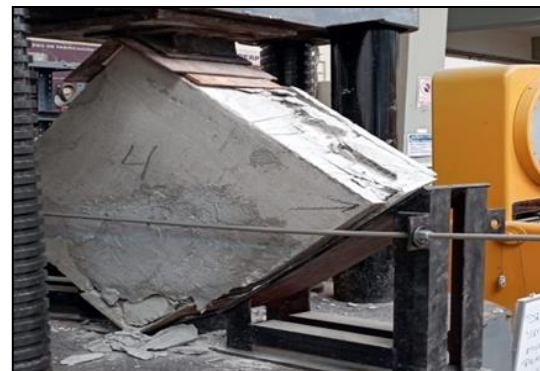
Fig. 12. M-4 Obtuvo una carga máxima (kg) 1500
